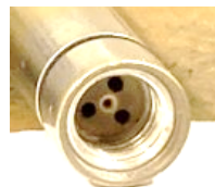
削れて穴が拡大した ハンドピース内部
