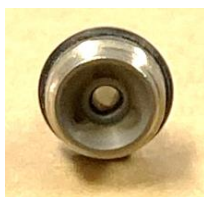
削れて穴が拡大した 先端ノズル
