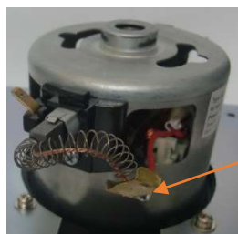
図8 新しいカーボンブラシの挿入
