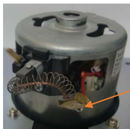
図8 新しいカーボンブラシの挿入
