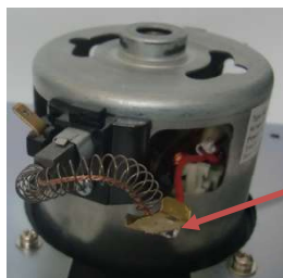
図8 新しいカーボンブラシの挿入
