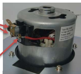
図9 カーボンブラシ交換完了
