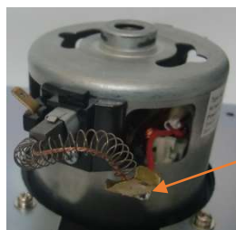
図8 新しいカーボンブラシの挿入
