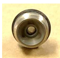
削れて穴が拡大した 先端ノズル
