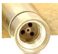
削れて穴が拡大した ハンドピース内部
